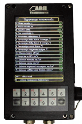
Вывод мгновенных значений параметров работы локомотива на блоке БР-7 РПДА в кабине управления
